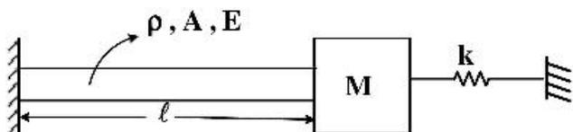
$$\tan \frac{\omega \ell}{C} = \frac{(M\omega^2 - k)C^2}{AE\omega C} \quad (1)$$
